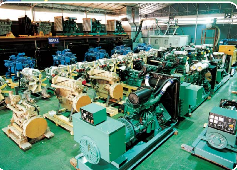
▶ 공장 전경(B동) - 엔진 및 발전기 SETS (Engines & Generator Sets)
